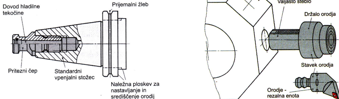
Slika 23: Orodni sistemi (frezalni stroj – levo, stružnica – desno) [22]
