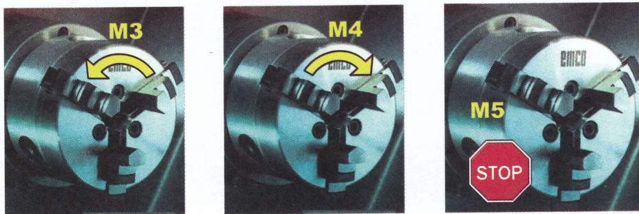
Slika 57: Vrtenje glavnega vretena na stružnici
