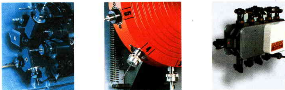
Slika 14: Naprave za menjavo orodij [19] (revolverska glava z gnanimi orodji – levo, boben – na sredini, verižni zalogovnik – desno)
