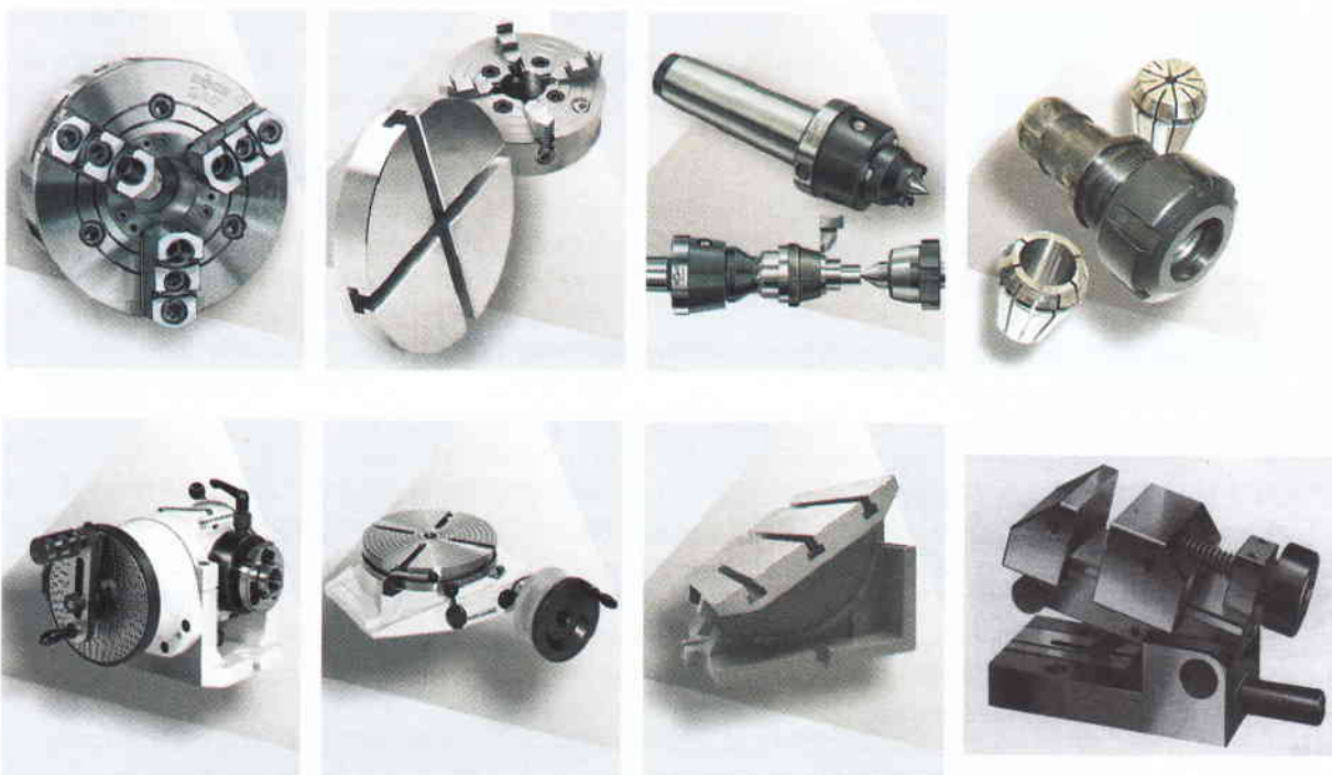
Slika 13: Vpenjalne priprave za stružnico (zgoraj) in frezalni stroj (spodaj) [17]
