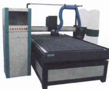
Slika 17: CNC-stroje za plamensko rezanje, lasersko rezanje in rezanje z vodnim curkom
